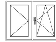
Fenêtre 2 vantaux avec battement central mobile
